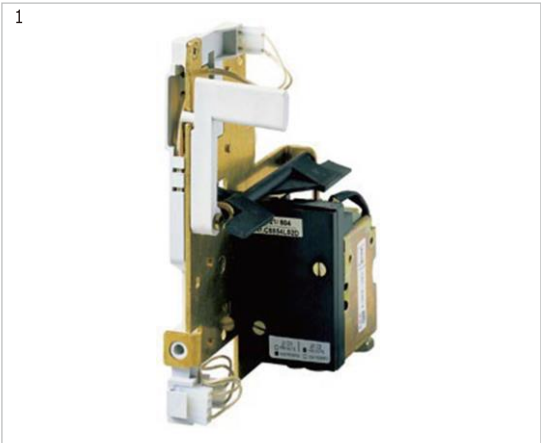
選項附件 1 並聯分閘脫扣器 ( -MO1 ) 可實現斷路器分開的遠方控制。
